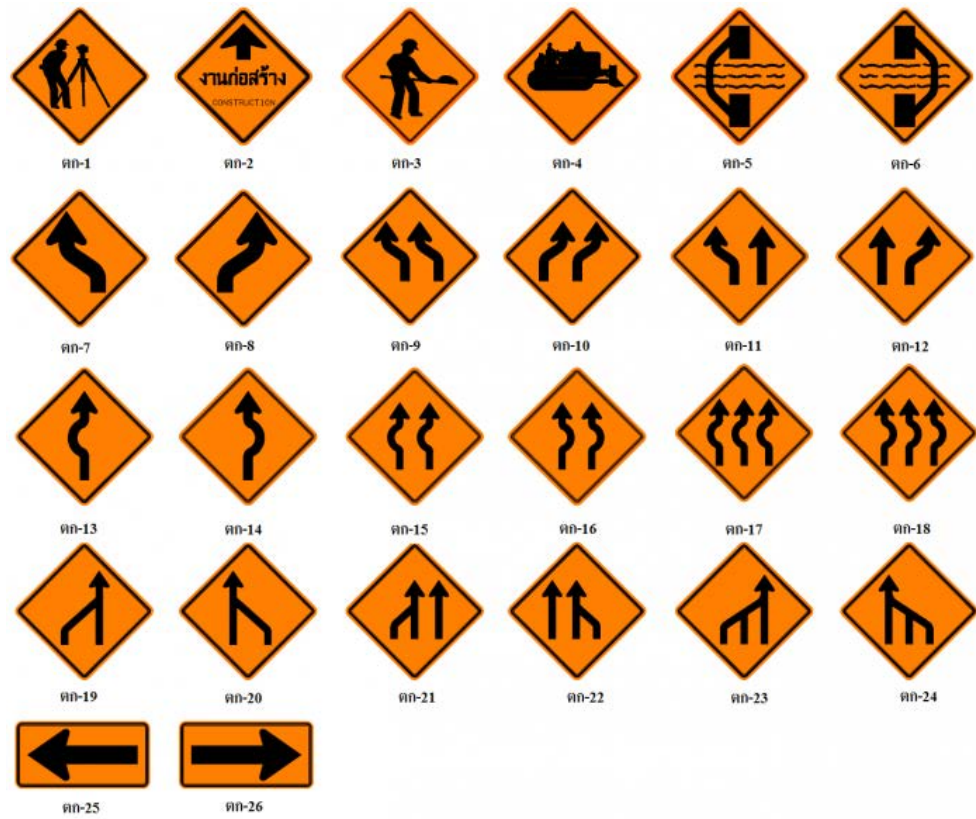
รูปที่ 2.1-1 ป้ายเตือนระหว่างการก่อสร้างและป้ายแสดงการเบี่ยงจราจร
