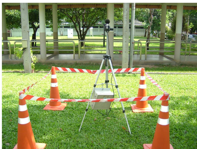
การติดตั้งเครื่องวัดระดับเสียง
