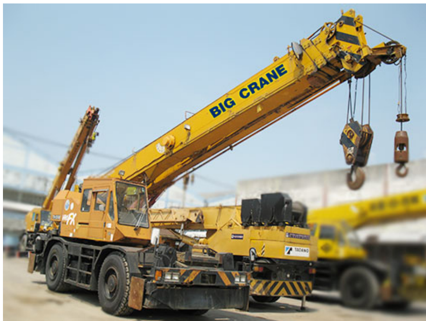
รูปที่ 2.2-2 ปั่นจั่นชนิดเคลื่อนที่ (Mobile Crane)
