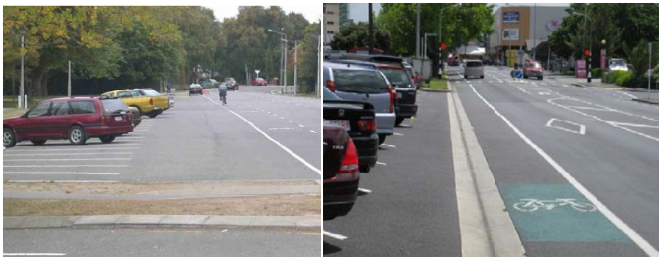
รูปที่ 17 การกันพื้นที่ระยะห่างระหว่างรถจอดมุมเฉียงกับช่องจราจรจักรยาน
