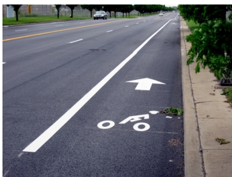
รูปที่ 16 ทางจักรยานแบบช่องจราจรจักรยาน (Bicycle Lane) กรณีห้ามจอดรถ (ซ้าย) และจอดรถได้ (ขวา)
