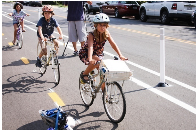
รูปที่ 7 การใช้เสาสจัดพื้นที่เฉพาะสำหรับจักรยาน (City of Austin)
