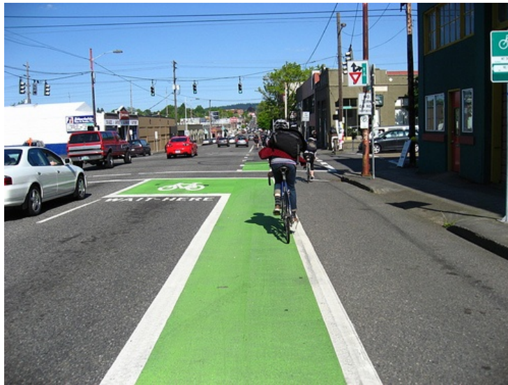
รูปที่ 25 การใช้สีบนพื้นผิวทางจักรยาน
