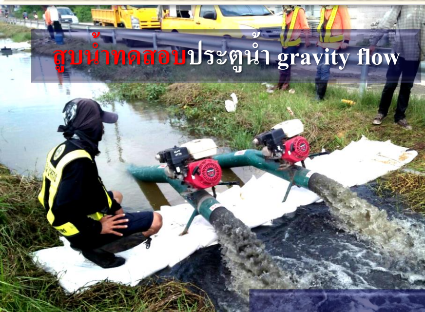
ผลการทดสอบ สามารถเปิดปิดบานด้วยหลัก Gravity
