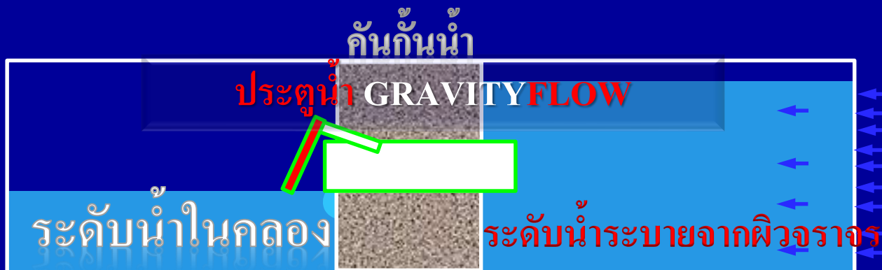
รูป B แสดงการระบายน้ำหลักการ GRAVITY
