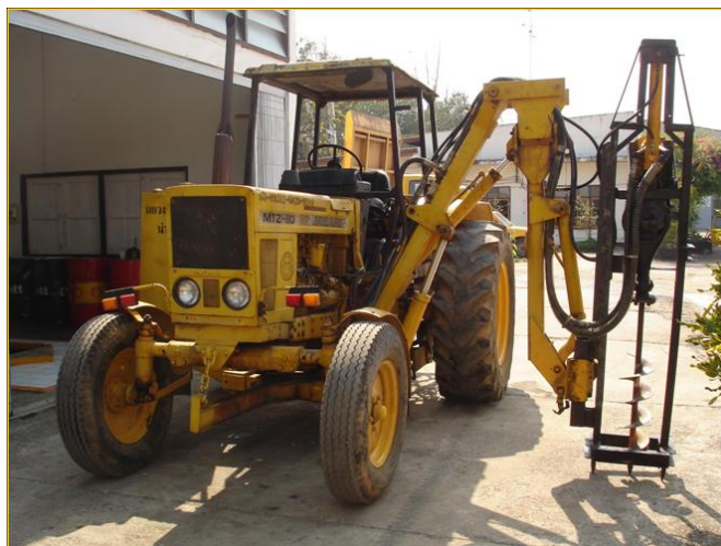
รูปเครื่องเจาะหลุมติดตั้งร่วมกับรถฟาร์มแทรกเตอร์
