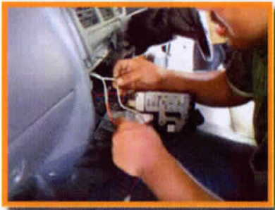
4. ต่อสายไฟและสายลำโพง
