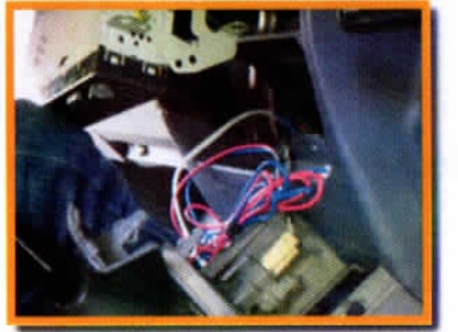
2.ถอดแผงคอลโซลเดินสายไฟและสายลำโพง
