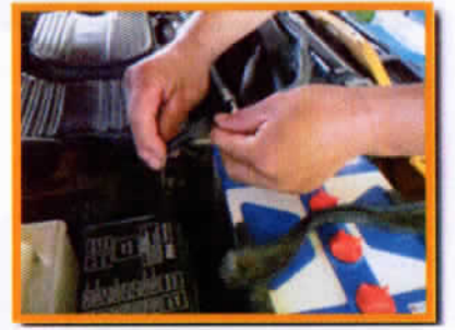
1.ประกอบฟิวส์เดินสายไฟไปที่ห้องโดยสาร
