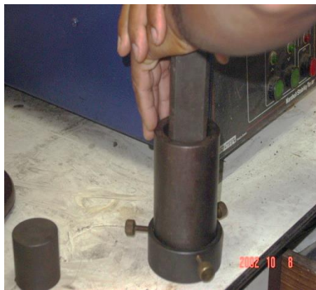
รูปที่ 3.28 ใส่ตัวอย่างทดลองลงใน Mold ทดสอบและวางแหวน ติดตั้ง Plunger ตัวบนลงบนตัวอย่าง
