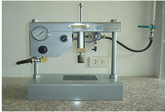
รูปที่ 3.9 เครื่องมือทดสอบ Cohesion Tester แบบใช้แรงดันจากเครื่องอัดอากาศ ซึ่งใช้งานอยู่ในปัจจุบัน
