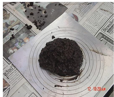
รูปที่ 3.4 ค่า Flow อยู่ระหว่าง 10 - 20 มม.
