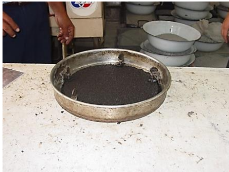
รูปที่ 3.15 การประกอบเข้ากับฐานรองรับภาตของเครื่องกวน Hobart C-100
