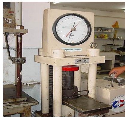
รูปที่ 3.25 เพิ่มแรงดันจนกระทั่งได้ความดัน 3000 psi รักษาระดับความดันนี้ 2 นาที
