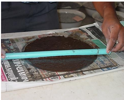
รูปที่ 3.13 การกวาดปาดวัสดุผสมพาราสเลอร์ซีล
