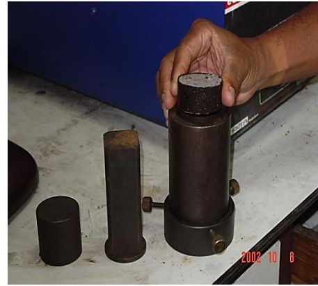
รูปที่ 3.27 ใส่ตัวอย่างทดลองลงใน Mold ทดสอบและวางแหวน
