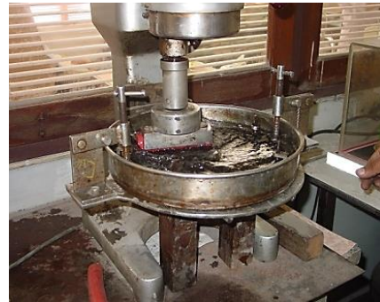
รูปที่ 3.15 การประกอบเข้ากับฐานรองรับภาตของเครื่องกวน Hobart C-100
