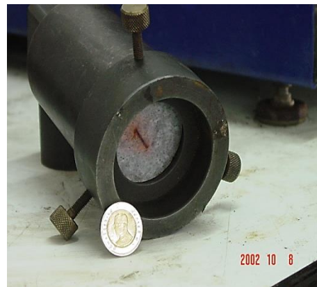
รูปที่ 3.28 ใส่ตัวอย่างทดลองลงใน Mold ทดสอบและวางแหวน ติดตั้ง Plunger ตัวบนลงบนตัวอย่าง
