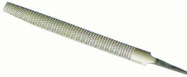
รูปที่ 5.12 แสดงตะไบหยาบหรือบั้ง
