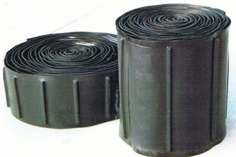
รูปที่ 1.12 แผ่นกันรากแบบ pvc (ที่มา http://www.citygreen.com/assets/Linear-Root-Barriers-with-root-diversion-ribs.jpg ) แผ่นหรือแผ่นกันรากดังกล่าว มีการผลิตออกมาในต่างประเทศนานแล้ว มีทั้งเป็นแผ่นเหล็กอบสังกะสีและแผ่น pvc สำหรับดินในภาคกลางที่มีความเป็นกรดมาก แผ่น pvc จะทนทานกว่า
