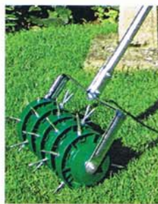
รูปที่ 8.13 การเจาะรูลงในดินใต้สนามหญ้าเพื่อให้เกิดช่องอากาศ
