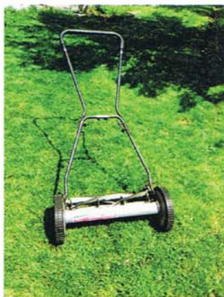
รูปที่ 8.7 แสดงเครื่องตัดหญ้าแบบเกลียวหมุน
