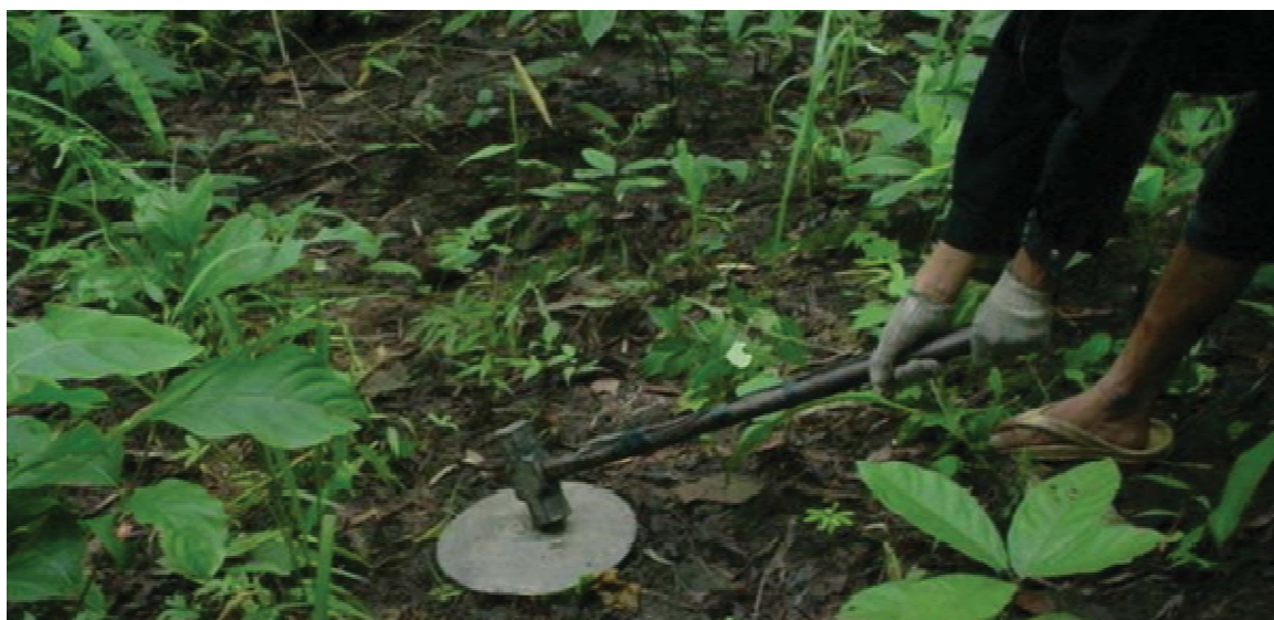
รูปที่ 3.1 แสดงการใช้ก้อนทูปแผ่นเหล็ก เพื่อเป็นแหล่งกำเนิดคลื่น
