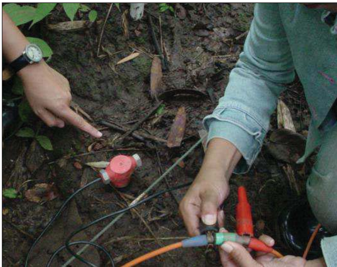
รูปที่ 3.6 แสดงการปักจีไอโฟน และการเชื่อมต่อสายนำสัญญาณ
