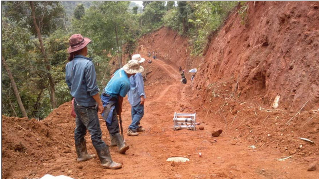
รูปที่ 3.11 แสดงการวางแผนสำรวจสำหรับการสำรวจด้วยคลื่นไหวสะเทือนแบบหักเห
