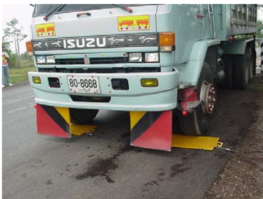
รูปที่ 8-9 การวัดน้ำหนักบรรทุกทุกในแต่ละเพล
