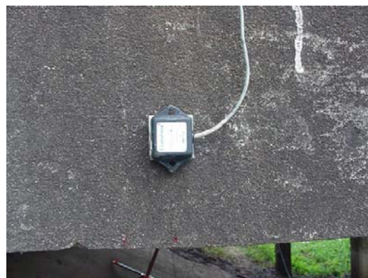
รูปที่ 8-13 ตัวอย่างการติดตั้งอุปกรณ์ตรวจวัดค่าความถี่ของโครงสร้าง
