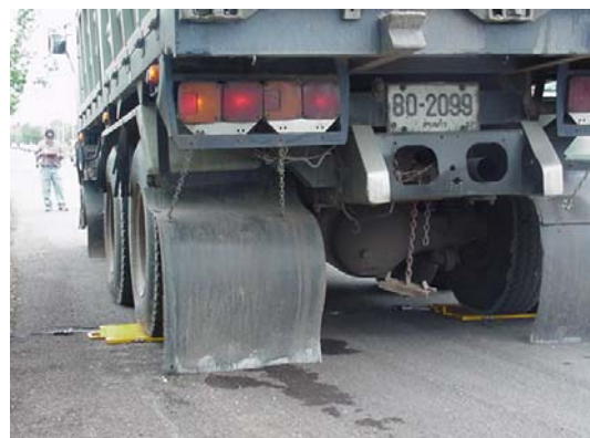
รูปที่ 8-9 การวัดน้ำหนักบรรทุกทุกในแต่ละเพล
