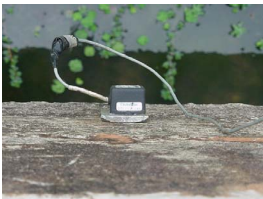
รูปที่ 8-13 ตัวอย่างการติดตั้งอุปกรณ์ตรวจวัดค่าความถี่ของโครงสร้าง
