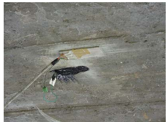
รูปที่ 8-12 ตัวอย่างการติดตั้งอุปกรณ์ตรวจวัดค่าการยึดหนืดของโครงสร้าง
