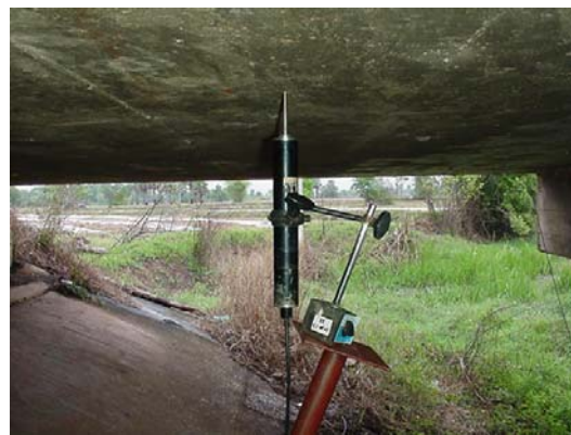
รูปที่ 8-11 ตัวอย่างการติดตั้งอุปกรณ์ตรวจวัดค่าการแอ่นตัว
