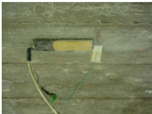
รูปที่ 8-12 ตัวอย่างการติดตั้งอุปกรณ์ตรวจวัดค่าการยึดหนืดของโครงสร้าง
