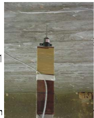
รูปที่ 8-11 ตัวอย่างการติดตั้งอุปกรณ์ตรวจวัดค่าการแอ่นตัว
