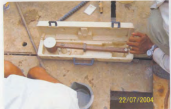
การทดสอบหาค่าความหนาแน่น (Density) ของน้ำปูน
