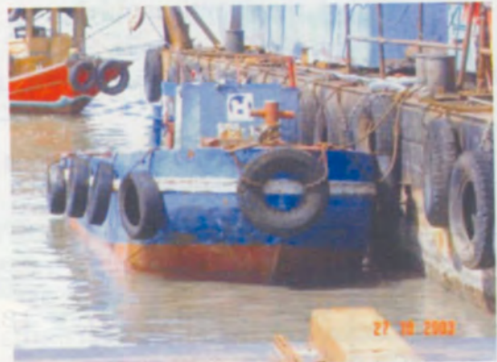
เรือเหล็กลากจูงกำลังขับเคลื่อน 200 แรงม้า
