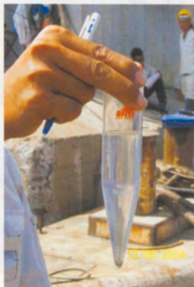
การทดสอบหาค่า Sand content ในสารละลายเบนโทไนท์
