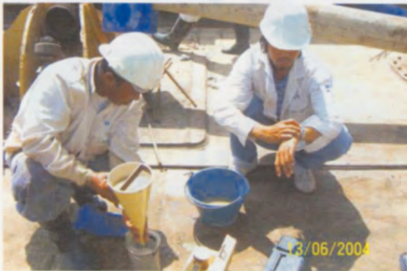
การทดสอบหาค่า Viscosity ของสารละลายเบนโทไนท์
