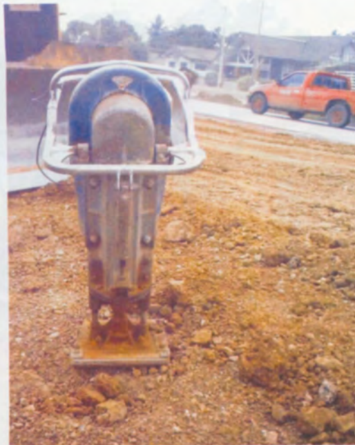
รูปที่ 27 เครื่องมือบดอัดดินด้านข้างกำแพง
