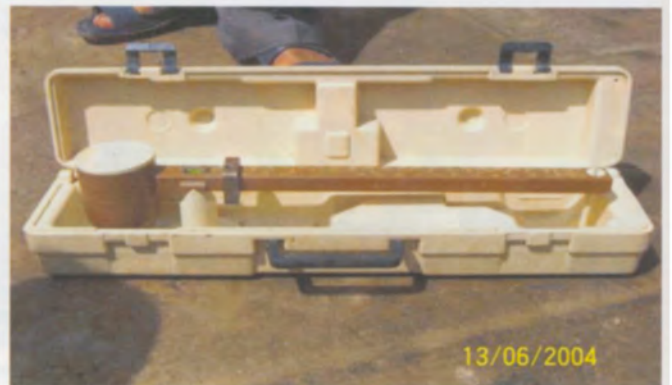
การทดสอบหาค่า Density ของสารละลายเบนโทไนท์
