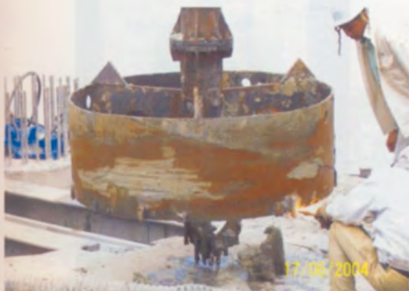
ก้านและหัวเจาะที่ใช้ในการขุดเจาะ โดยวิธี Reverse Circulation
