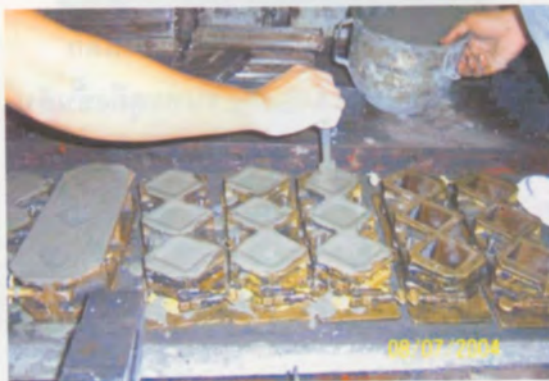
เก็บแท่งตัวอย่างขนาด 5x5x5 ซม. เพื่อทดสอบ Compressive Strength
