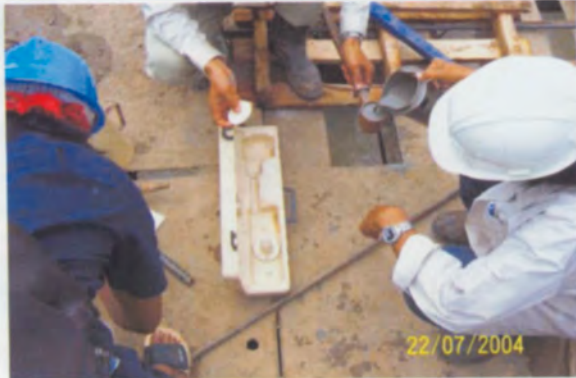
การทดสอบหาค่าความหนาแน่น (Density) ของน้ำปูน
