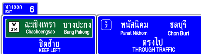
(ป้ายแนะนำการใช้ช่องจราจร
