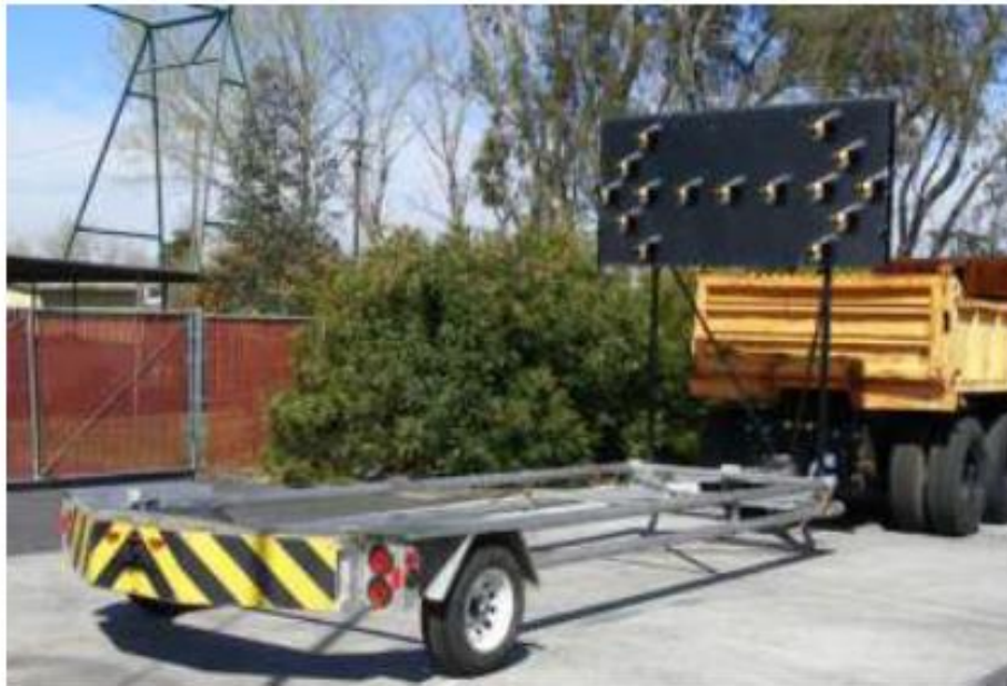
รูปที่ 6-8 ตัวอย่างรถกันชนพร้อมอุปกรณ์กันชนลดแรงกระแทก (Attenuator)
