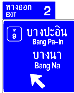
(ตัวอย่างการติดตั้งป้ายหมายเลขทางออก บนป้ายแนะนำชี้ทางออก)
