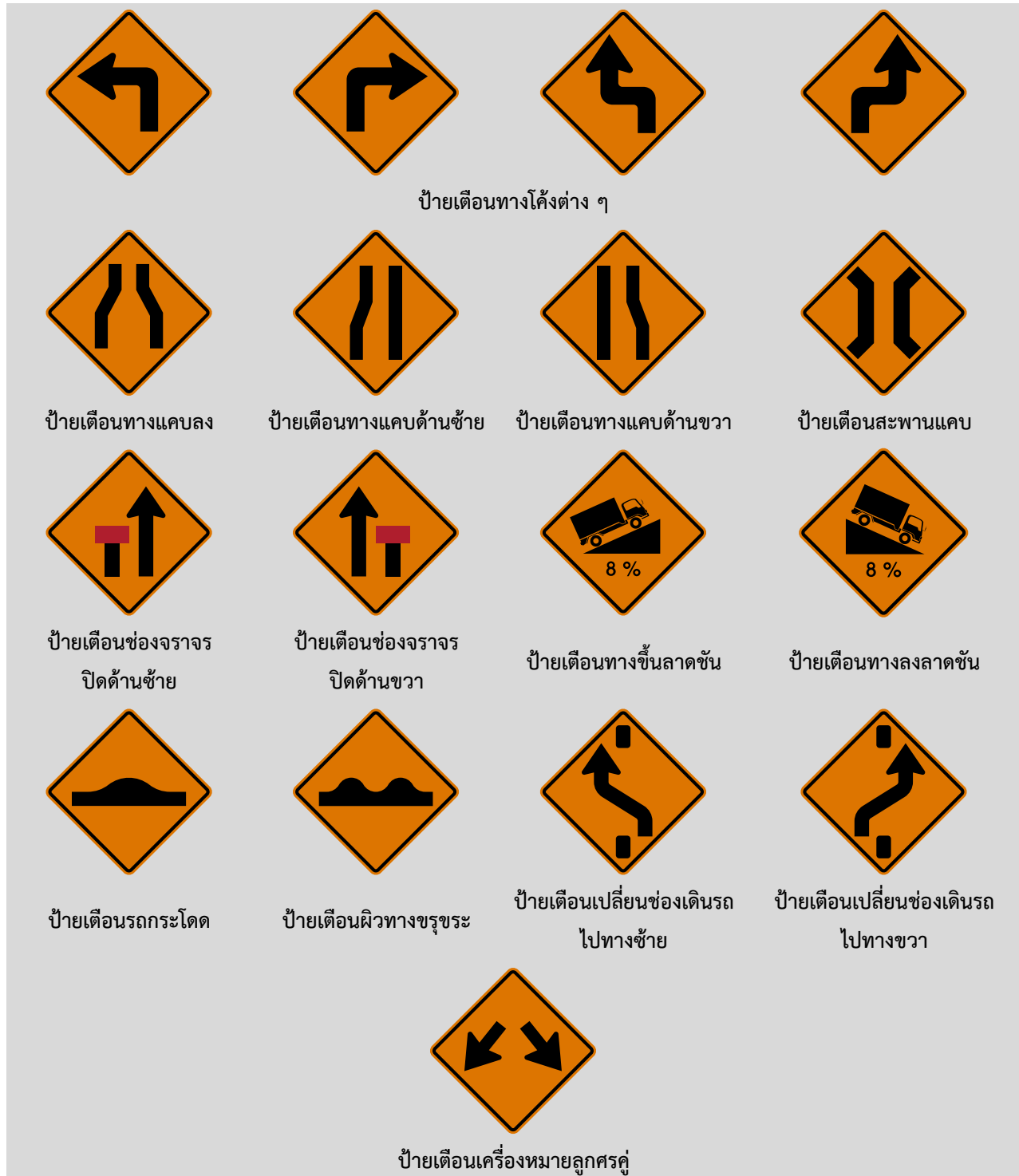
รูปที่ 7-5 ป้ายเตือนในงานก่อสร้างที่นำรูปแบบป้ายเตือน (สีเหลือง) มาปรับใช้
