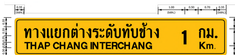
(ขนาดป้ายชื่อทางแยกต่างระดับ)
