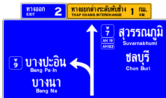
(ตัวอย่างการติดตั้งป้ายชื่อทางแยกต่างระดับ)
