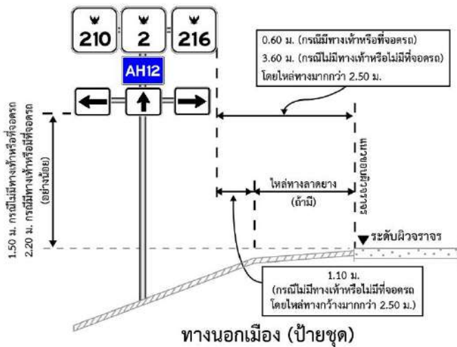
รูปที่ 1-1 มาตรฐานระยะการติดตั้งป้ายจราจรบนทางหลวงทั่วไป (ในเมืองและนอกเมือง)
