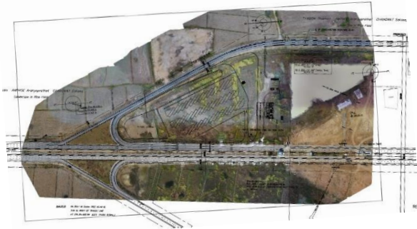
รูปที่ 12 การวางแผนแปลนของโครงการลงในภาพ Orthomosaic
