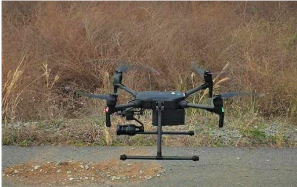
รูปที่ 4 อากาศยานไร้คนขับ DJI Matrice 200 series V2 ติดตั้งกล้อง ZENMUSE X5S
