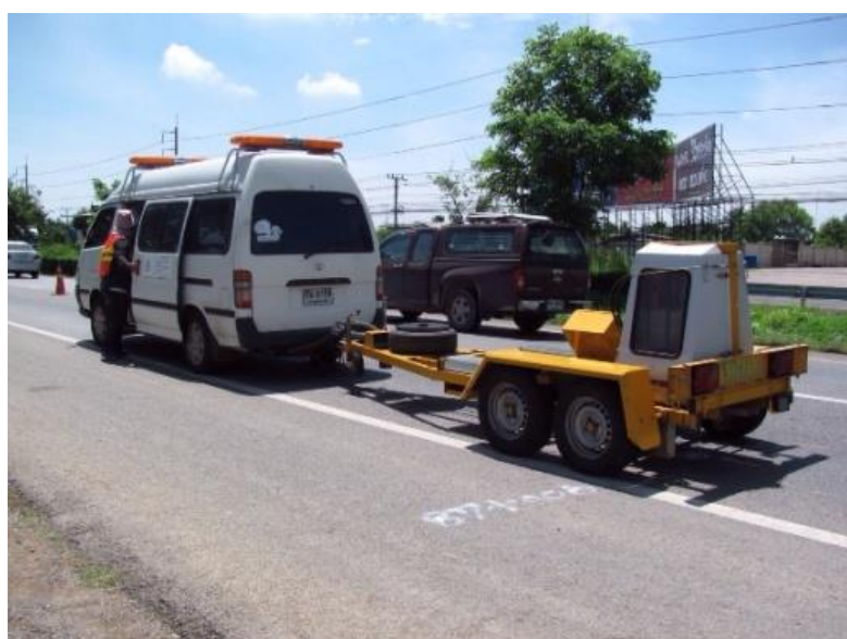
รูปที่ 3.1 การทดสอบด้วยเครื่องมือ FWD (ดนัยณัฐ และคณะ, 2561)
